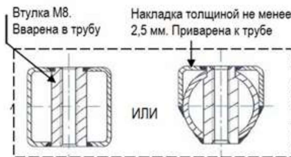
Рис.13. Дополнительный поперечный элемент в главной дуге
