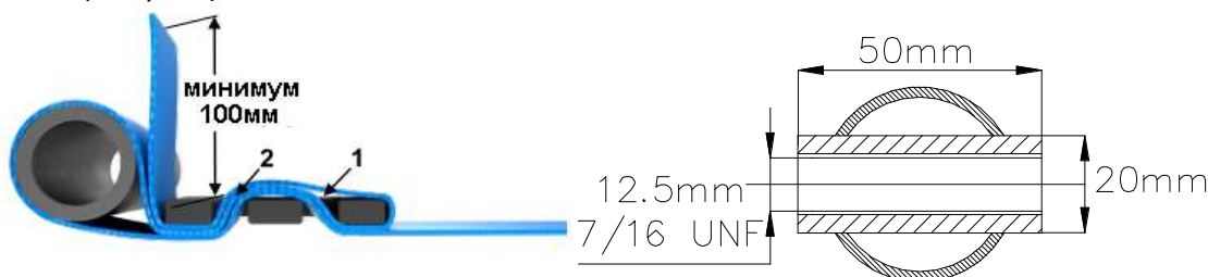
Рис.16. Вариант крепления ремня к трубе
