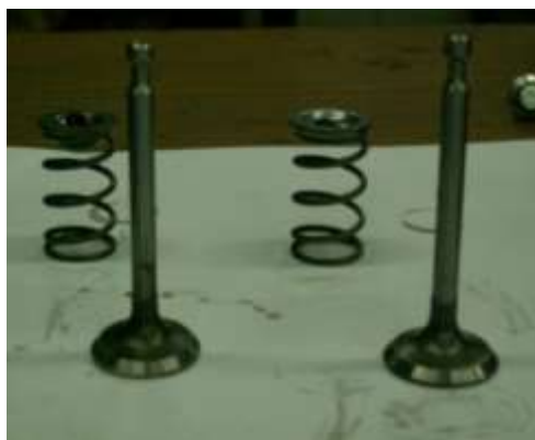
Фото 11.3-7. Клапаны и клапанные пружины демонтированные.
